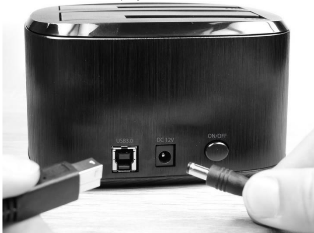
OBRÁZEK 1. Zapojení dokovací stanice.
