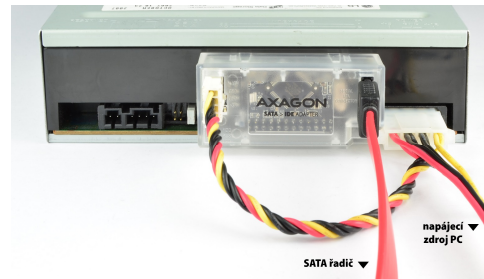
OBRAZEK 2: Propojení s ATAPI CD/DVD mechanikou.
